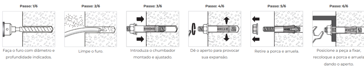
Figura 2. Chumbador mecânico do tipo CBA/CBE e método de aplicação.
